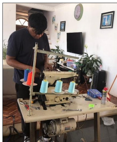
Le technicien installe la recouvreuse
